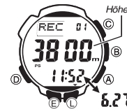
Wechselt zwischen Messzeit (Stunde : Minuten) und Messdatum (Monat, Tag)
